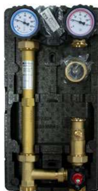
Насосная группа PrimoTherm 180-2 Vario с регулируемым 3-ходовым клапаном KvsVario (без привода, без насоса)
